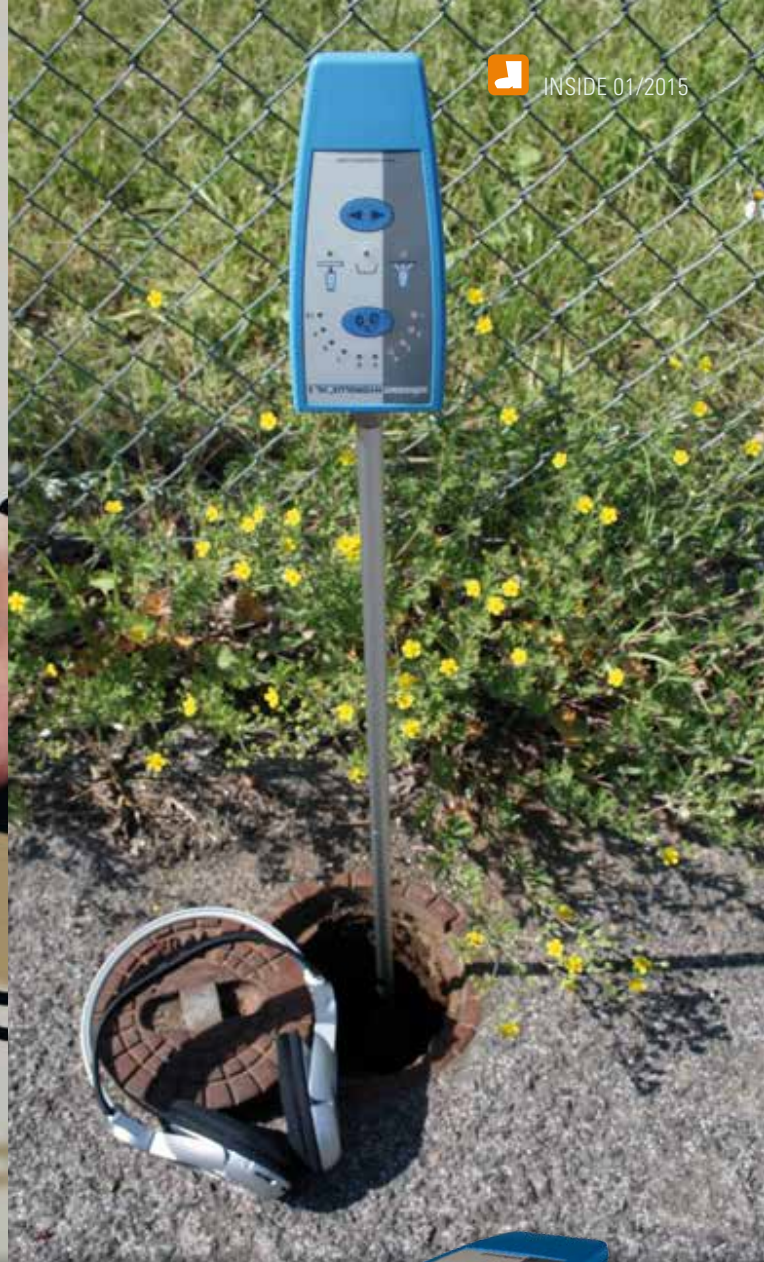
HYDROLUX HL 5 – Mini-Wasserlecksuchgerät mit akustischer und optischer Leckanzeige (Mobilgehäuse-Reihe SMART-CASE).
