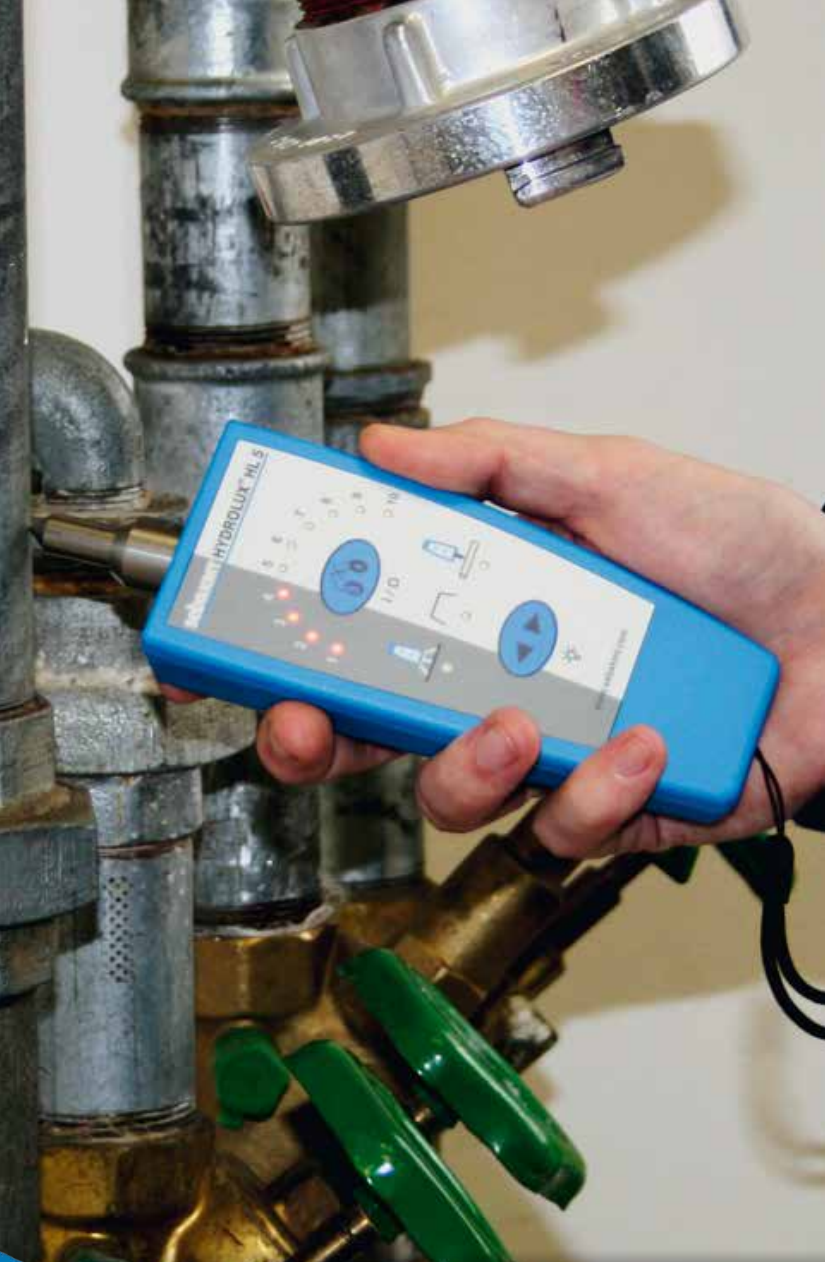
HYDROLUX HL 5 – Mini-Wasserlecksuchgerät mit akustischer und optischer Leckanzeige (Mobilgehäuse-Reihe SMART-CASE).
