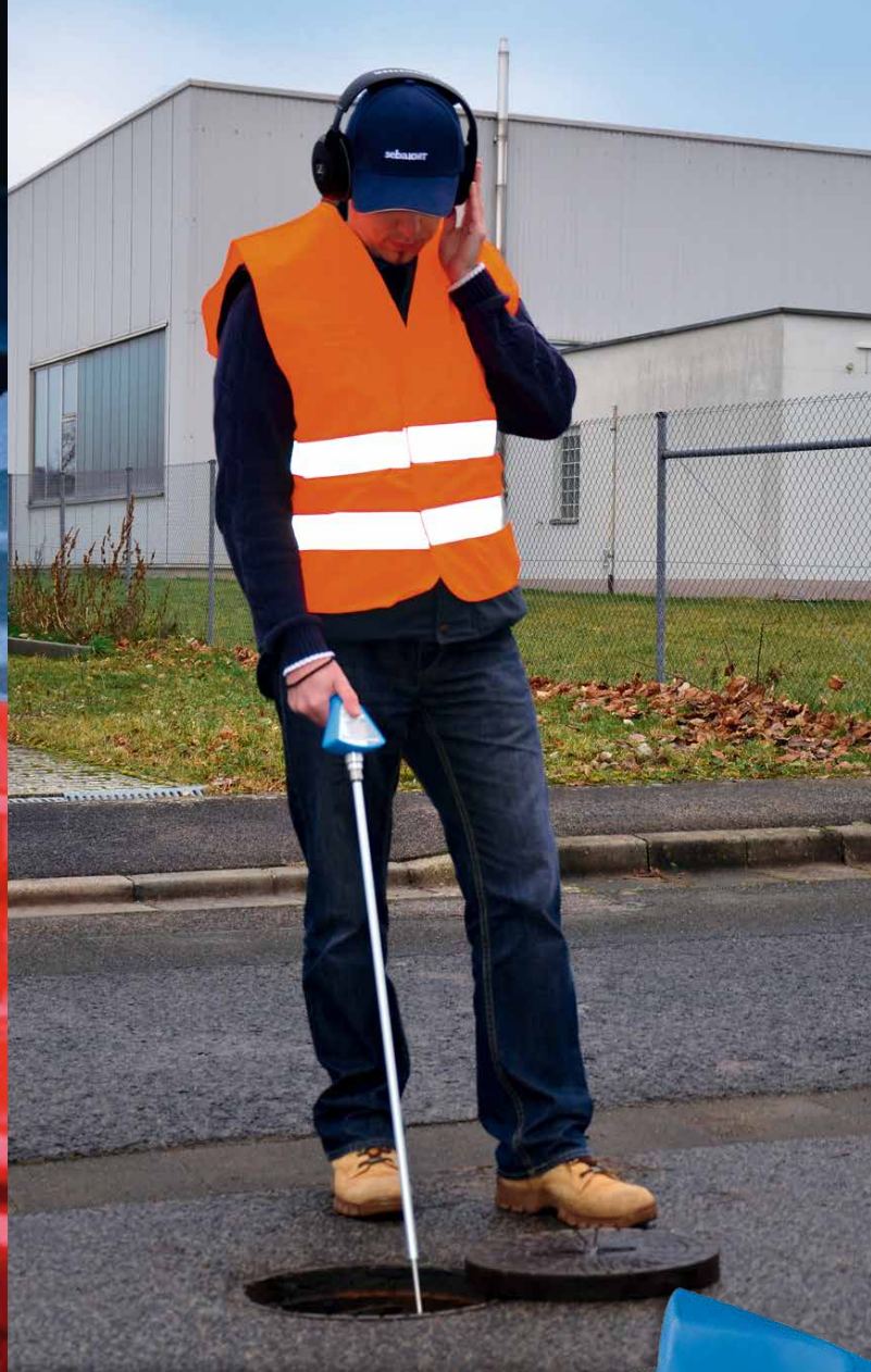
HYDROLUX HL 50 – Tragbares Leckageortungsgerät mit integriertem Sensor und kabellosen Funkkopfhörern.
